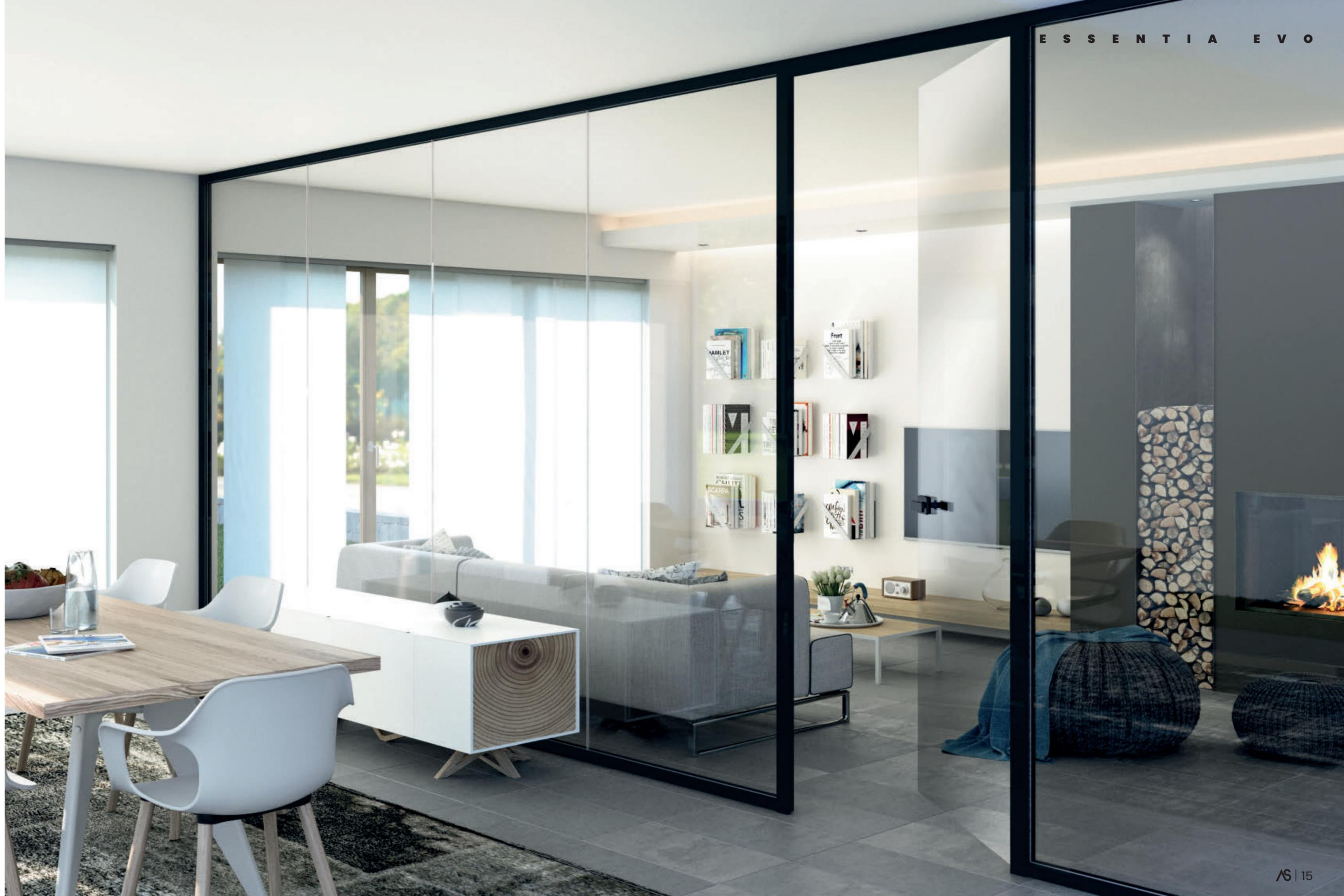
ESSENTIA: una parete composta interamente di vetro che dona luminosità e leggerezza a ogni tipo di ufficio. La sua soluzione mono-vetro, con spessore 5+5 o 6+6 mm, profilo inferiore da 80 mm e superiore da 60 mm e spessore parete complessivo di 55 mm, è in grado di compensare eventuali dislivelli fino a 40 mm e garantisce buone performance acustiche.
